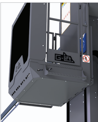
A tampa inferior do cesto protege o mecanismo de extensão. O sistema de ranhuras é responsável por descarregar a granalha fora do cesto.
